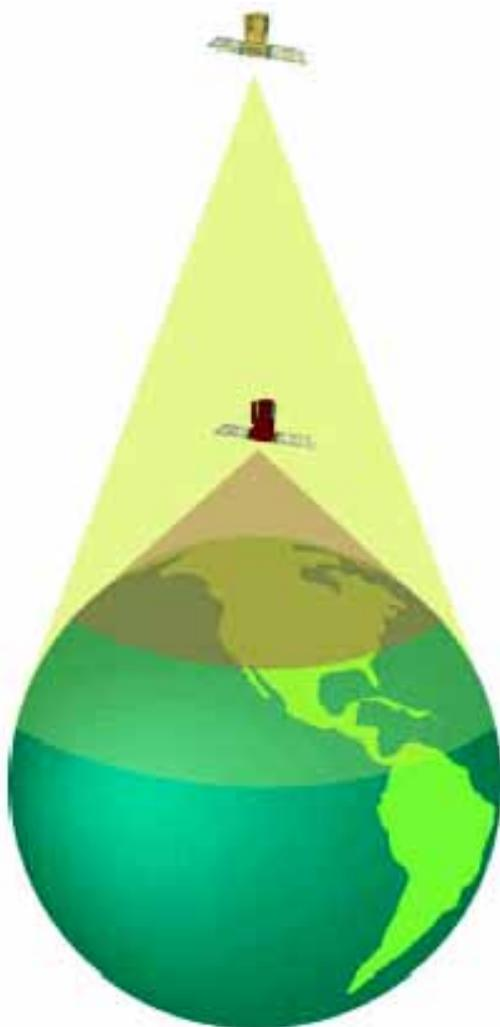
表5.1列举了在几种高度上的卫星的最大覆盖面积的半径和当最小仰角是 $10^\circ$ 时有效覆盖面积的半径。注意到低轨卫星的有效覆盖面积大约是最大覆盖面积的一半，而高轨卫星的有效覆盖面积相对于最大覆盖面积却没有减少那么多。还要注意，与低轨卫星相比，地球同步轨道上的卫星能够看到地球上更大的区域。
